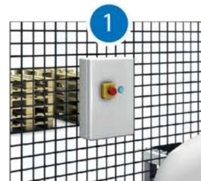
Betätigung des Pre-Reset-Tasters innerhalb des Gefahrenbereichs der Maschine
