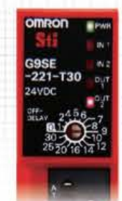
Fehler bei der Einstellung der Abschaltverzögerung
